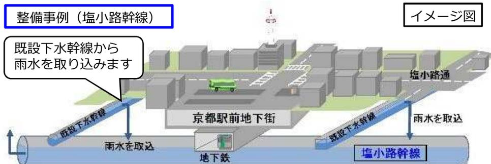
降雨終了後、貯留した雨水を下流の既設下水幹線に排水します。
