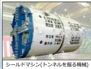
シールドマシン(トンネルを掘る機械)
