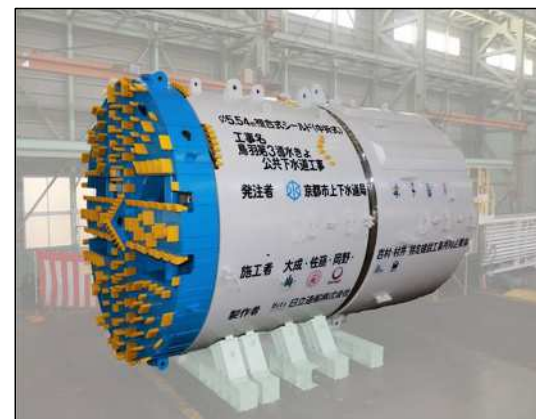
鳥羽第3導水きょ シールド掘進機
